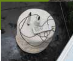
Chambres manuelles de mesure de la respiration du sol et d'échange net de l'écosystème. © F. Laggoun
